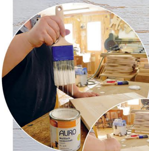
2. Mit der Lasur oder Farbe der Wahl streichen, ggf. mehrfach. Gut trocknen lassen.
