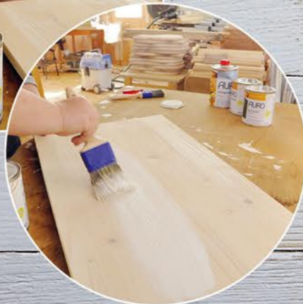
2. Mit der Lasur oder Farbe der Wahl streichen, ggf. mehrfach. Gut trocknen lassen.
